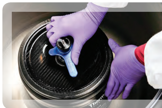
Figura 9: Asa de control de la velocidad en las tapas del rotor: ofrece mayor seguridad al cerrar la tapa y simplifica su retirada.
