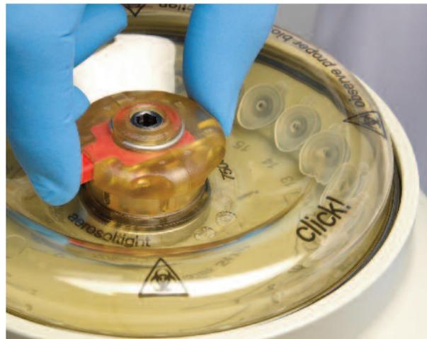
Primera tapa de biocontención de la industria, la ClickSeal va provista de un sistema de cierre y apertura del rotor ergonómico y certificado.
